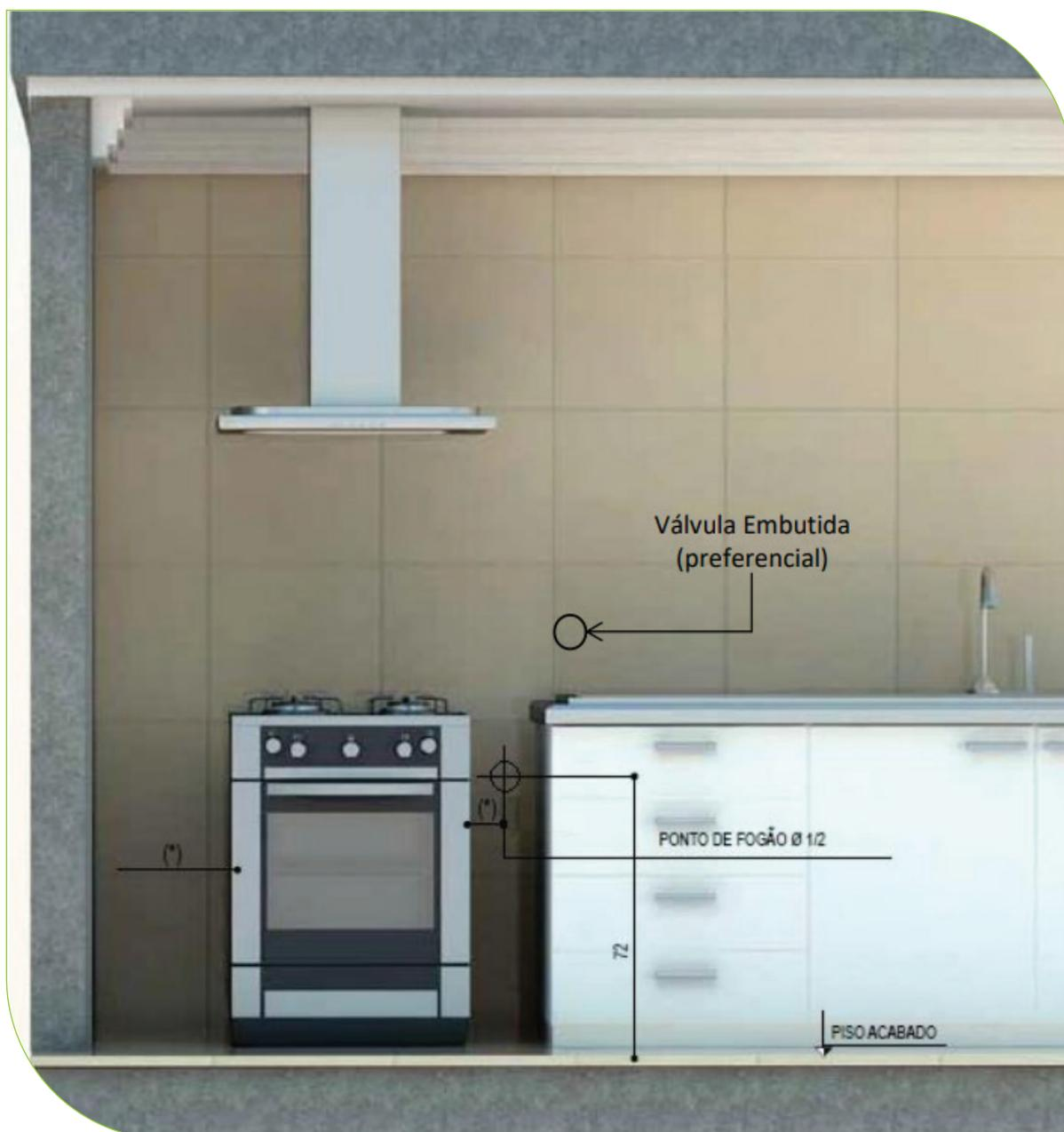
**FIGURA 13:** Posicionamento do ponto de utilização para fogão de piso
