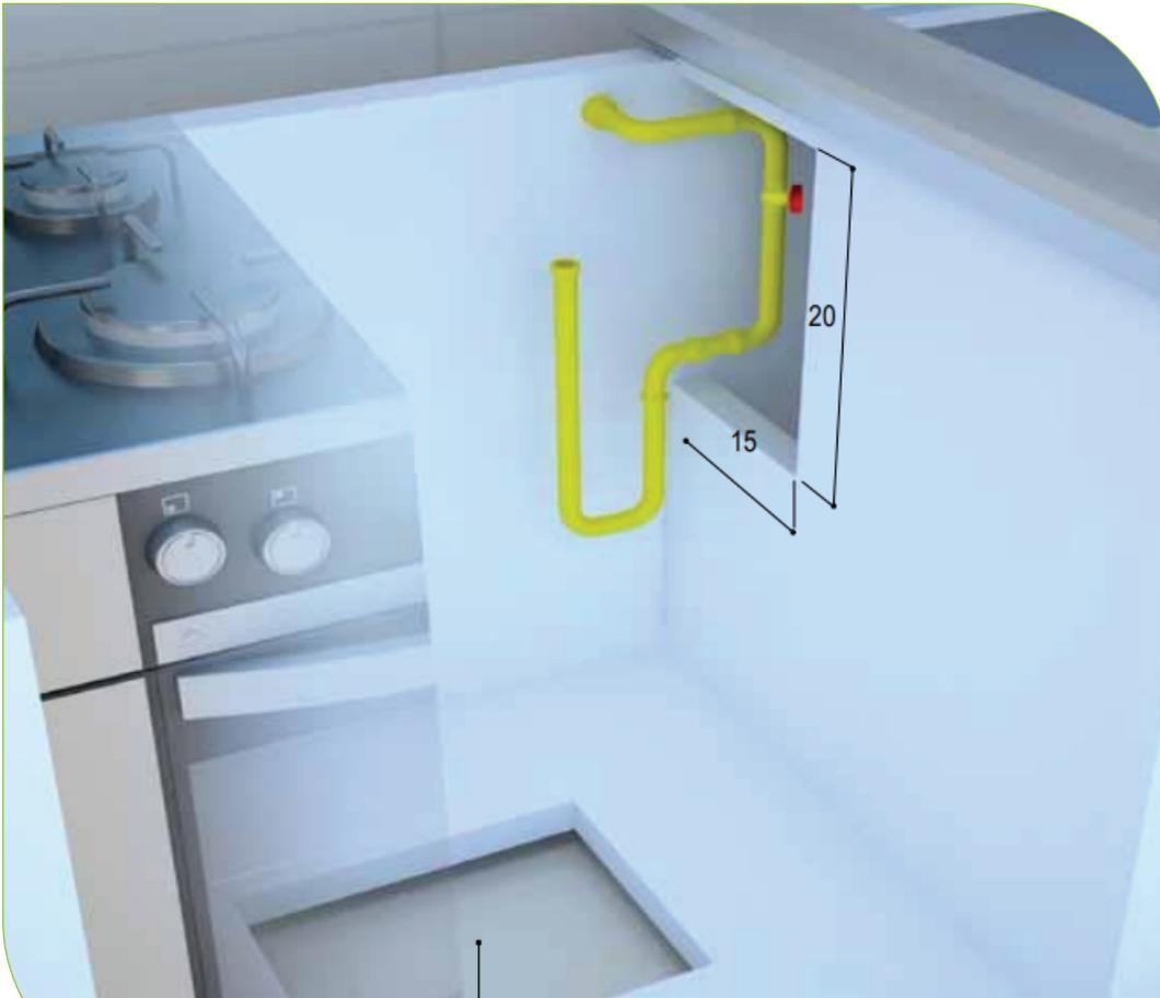
POSICIONAMENTO DO PONTO DE INSTALAÇÃO
